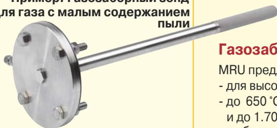
Зонд из нержавеющей стали до 900 °C с фланцем DN 65 PN 6 с металлокерамическим фильтром 3 мкм.
