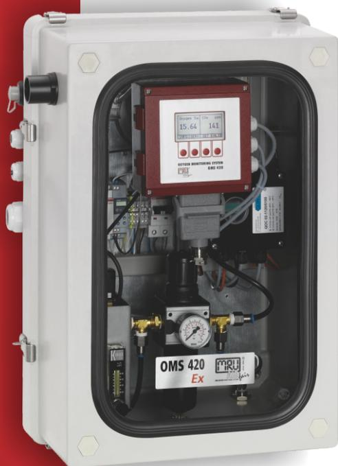
Обычно, для контроля режимов сгорания в котлах и печах, используют только измерение O<sub>2</sub>. Измерение 2-х компонентов (O<sub>2</sub> и хим. недожога CO<sub>e</sub>) позволяет снизить избыток воздуха до уровней, которые ранее были не достижимы. В результате пользователь имеет преимущества: снижение расхода топлива и снижение выбросов NO<sub>x</sub>. Также, данное решение позволяет проводить качественный контроль сгорания при наличии присосов в дымоходах.
