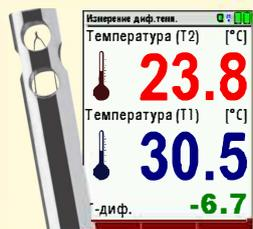
2 канала измерения термopарами (тип K и S)
